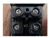
**3.** Afloje el tornillo NEUTRO e Inserte el cable NEUTRO (color blanco) cuidando que este entre perfectamente entre las dos placas metálicas como se muestra en la imagen. Una vez insertado, apriete nuevamente el tornillo para que el cable quede fijo.
