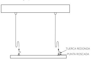
**B)** Acomode el cable de acero inoxidable sobrante pasándolo por el orificio que está aun lado de la punta roscada y enróllelo como se muestra en el DIBUJO B.
